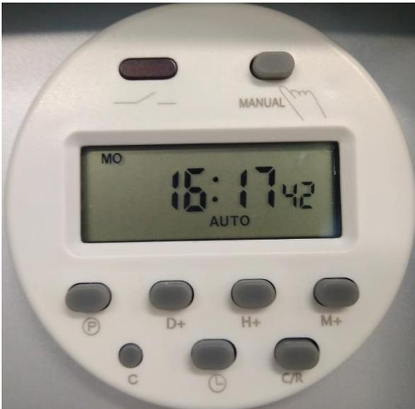
P - таймер включения/выключения в AUTO режиме
